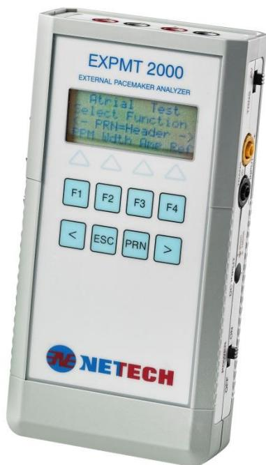
*EXPMT 2000 prüft die unterschiedlichen Systeme externer Herzschrittmacher, die in kardialen Ausnahmesituationen im Klinikbereich eingesetzt werden.*
